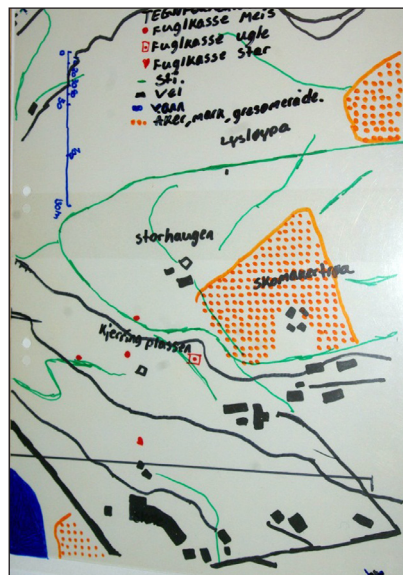
Figur 4. Ferdig temakart der fire lag med kartinformasjon er lagt over hverandre. Merk at de ulike kartlagene har kryss i hjørnene, kartinnpassningspunkter for at de ulike lagene skal kunne legges korrekt over hverandre.
