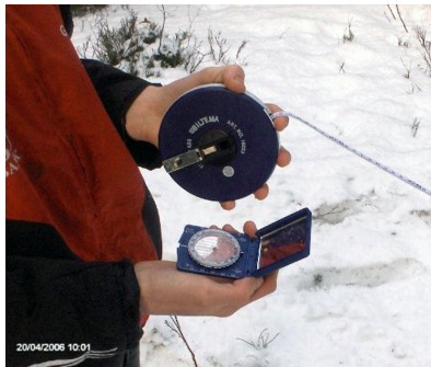
Figur 2. Speilkompass og målebånd brukt i Kompass-gruppa.
