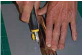
Med en tapetkniv skjærer du tvers over hele plata langs en metallinjal – ca 1/3 av platetykkelsen.
