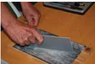
Pushing av kanter: Kuttflaten vil være hvit der den er brukket av, denne bør pusses vekk. Et ark smergel eller sandpapir limt på en plate er et enkelt hjelpemiddel for pushing. All sliping bør gjøres før du knekker plasten. Det kan være vanskelig å komme til med pushing etterpå.
