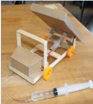
Lasteplanet er en vektstang som løftes hydraulisk.
