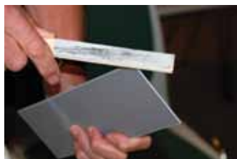
Elevene kan lage sine egne filer. Avrunding av hjørner gjøres lett med fine filer (for metall). Figuren viser en enkel fil der en strimmel smergel er limt på en liten flat trelist – grovere smergel på den ene siden og finere på den andre.
