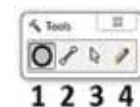
Figur 3 Tools – verktøykasse. Finnes også som nedtrekk på menylinja øverst. Verktøy 1: velg knutepunkt, verktøy 2: velg stav/bjelke, verktøy 3: pek ut knutepunkt eller en stav og verktøy 4: velg viskelær
