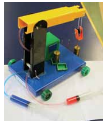
Kran med teleskoparm, hydraulisk styrt (rød). Bommen løftes hydraulisk (blå) og talje med sveiv.
