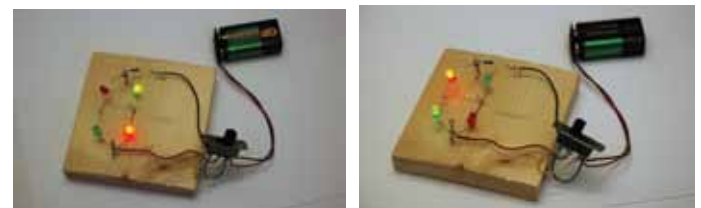
Figur 4a og 4b. I prinsippet er dette et enkelt trafikkllys.
