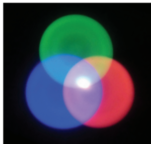
Eksempel på en kraftig LED-lykt der rødt, grønt og blått filter viser blandingsfargene.
