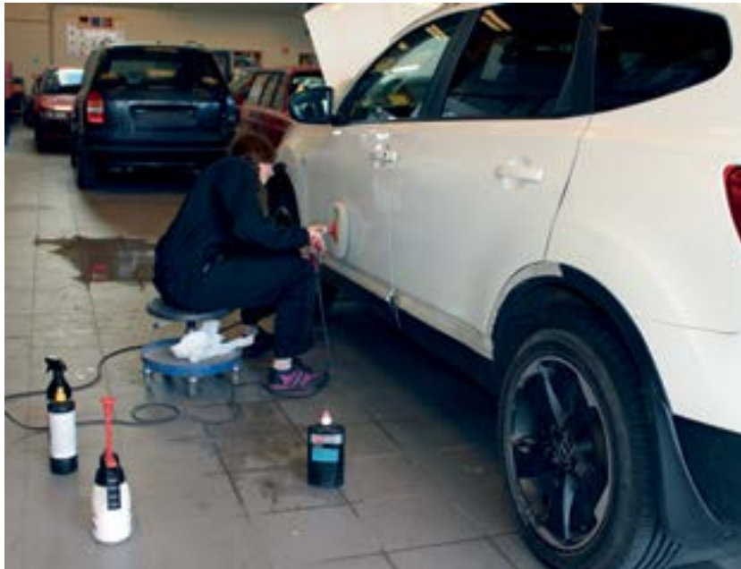
Lakkpleie utføres av en elev. Foto: Hilde Ervik
