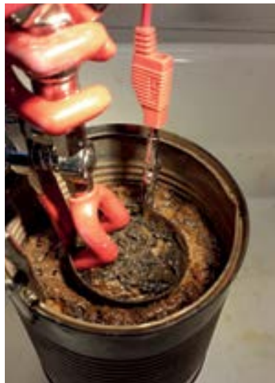
Myrmalm dannet under elektrolysen
