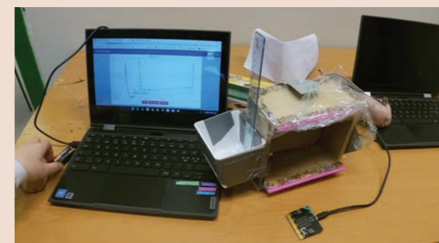
Logging av data fra værstasjonen med Ubitlogger.
