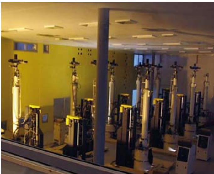
Hallen hvor det trekkes opp ingoter fra silisiumet. Denne befinner seg i NorSuns virksomhet i Årdal.
