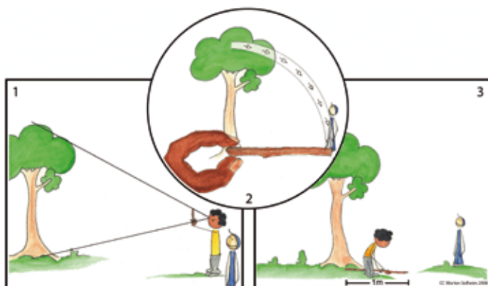
Metode for å måle høyden på et tre. Illustrasjon: Morten Solheim
