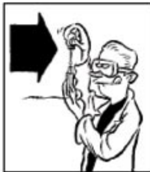
Snu pipetten og fyll den helt med vann tilsatt natriumsulfat og BTB
